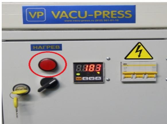
Теперь нужно быть готовым к тому, что плита Стола разогрета и новые, ещё не прогретые заготовки, могут на непродолжительное время изгибаться. По мере их прогревания они полностью опадут на поверхность плиты Стола нагрева.
