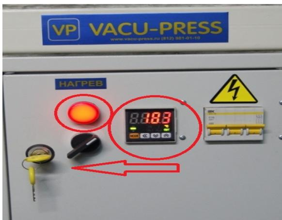
Произойдёт подача электотока на нагревательные элементы. Загорится красная лампочка и начнётся нагрев плиты стола до температуры заданной на ТК. Значение температуры будет отображаться на красном цифровом дисплее PV.
