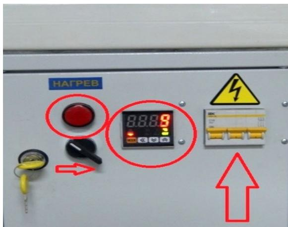
Произойдёт подача электротока на **ТР**. Подсветятся две строки дисплея. Дисплей текущего значения температуры PV (красный). На нём отобразится текущая температура плиты стола нагрева. Если стол долго не включался то **ТР** покажет температуру в помещении.
