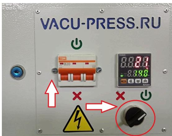
Произойдёт подача электротока на нагревательные элементы. Начнётся нагрев плиты стола до температуры заданной на ТР. Значение температуры будет отображаться на красном цифровом дисплее PV.
