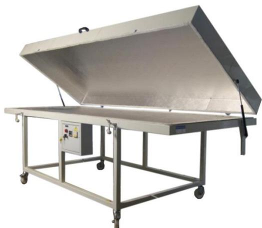
Нагревательные столы серий Industrial HT и Professional HT предназначены для предварительного нагрева заготовок из термопластичных материалов, таких как искусственный камень (Corian, Hi-Max, Staron), метакриловых пластиков, ПВХ и т.д. с целью их последующего 3D-формования в вакуумных или гидравлических прессах.
